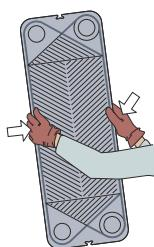
Откройте пакет пластин, сдвинув прижимную пластину по несущему стержню.
