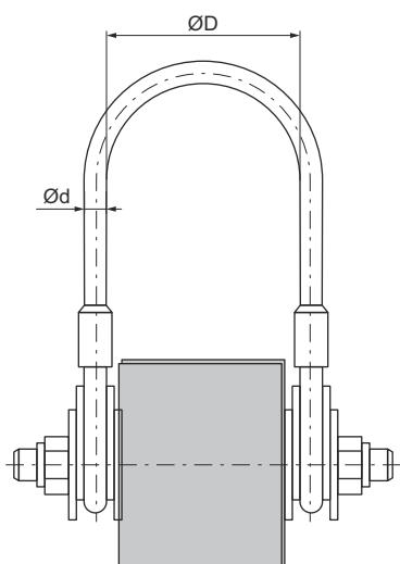
Рис. 5: Подъемный проволочный канат в сборе с опорной плитой.
