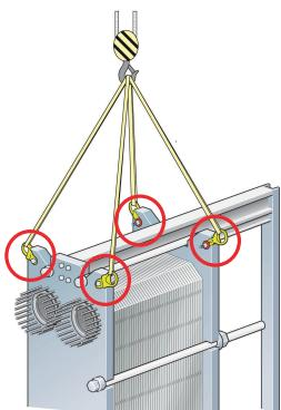
Рис. 7: Подъемное устройство для AQ18 и AQ14L. Крепежное оборудование не требуется.
