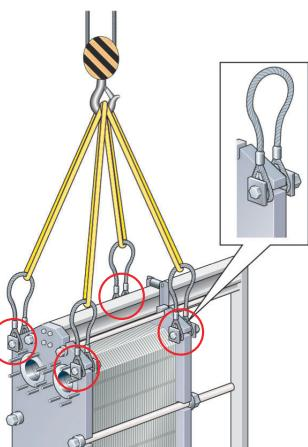
**Рис. 6: Подъемное устройство для AQ14 и AQ14S. Требуется крепежное оборудование.**
