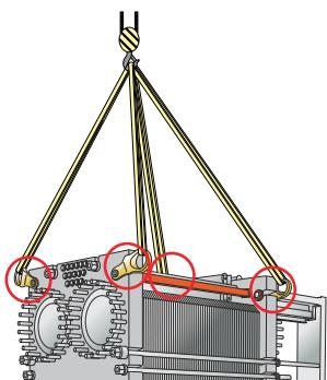
Рис. 8: Подъемное устройство для AQ20. Требуется крепежное оборудование.
