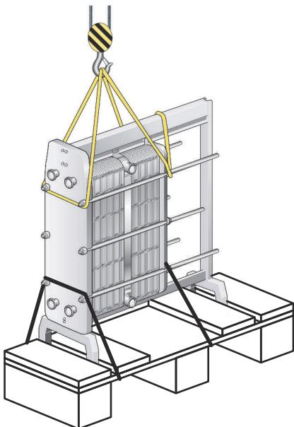
Снимите крепления, которыми оборудование зафиксировано на поддоне.
