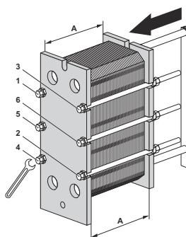
Затяните четыре болта (1), (2), (3), (4) или шесть болтов (1), (2), (3), (4), (5), (6) так, чтобы размер пакета пластин составлял  $1,10 \times A$ , при этом во время закрывания опорная и прижимная пластины должны располагаться параллельно.
