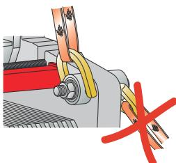
Рис. 9: Подъемное устройство для AQ20S. Используйте четыре внутренние проушины для подъема пластинчатого теплообменника. ЗАПРЕЩАЕТСЯ использовать крепежные точки, предназначенные для транспортирования! Требуется крепежное оборудование.
