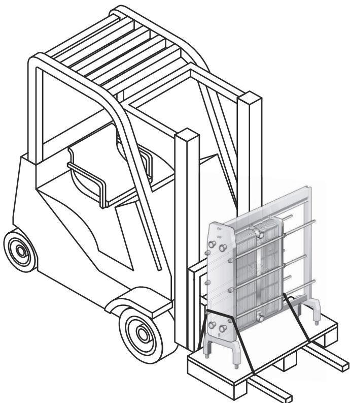
Прежде чем снять оборудование с поддона, закрепите его стропами так, чтобы обезопасить оборудование от возможного падения.
