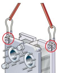
Рис. 8: Подъем оборудования AQ4T, AQ2T, AQ3, AQ2L
