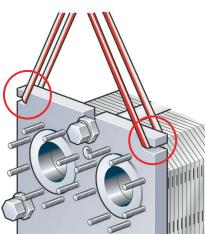
**Рис. 5: Подъем оборудования AQ1, AQ2, AQ4, AQ1A, AQ2A, AQ2S, AQ1L и более старых вариантов исполнения AQ3, AQ2L**
