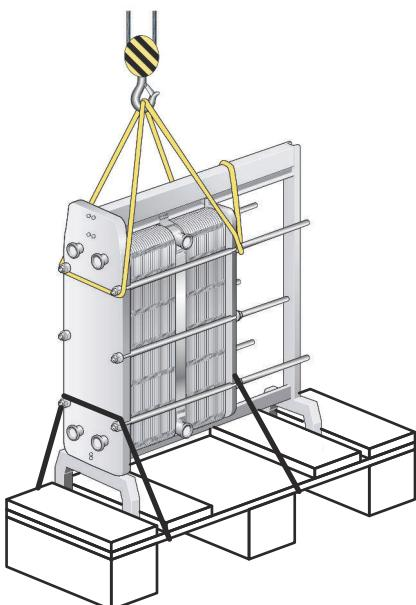
Снимите крепления, которыми оборудование зафиксировано на поддоне.
