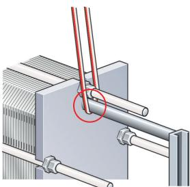
**Рис. 6: Подъем оборудования AQ1, AQ2, AQ4, AQ1A, AQ2A, AQ1L и более старых вариантов исполнения AQ3, AQ2L**
